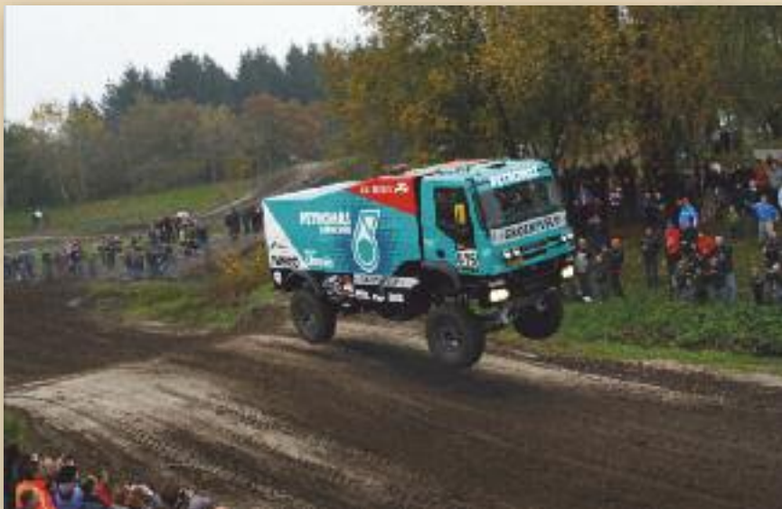
Автомобили Trakker оборудованы 6-цилиндровыми, 24-клапанными двигателями Cursor 13 с электронным впрыском и развивают мощность 840 л.с. Выше - вся команда, включая техников и механиков. Сверху - пилоты Мики Биазон и Жерар де Рой, вместе с Мауро Велья, старшим вице-президентом (легкие и средние грузовики) и менеджером Iveco по маркетингу.
